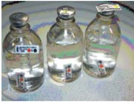
Рис.4. Контрольные флаконы с индикаторами, подготовленные для закладки в стерилизатор 1 - флакон с индикаторами Фарматест-Винар для закладки в контрольные точки №1 и №2; 2 - флакон с индикатором Фарматест-Винар-120/8 внутри флакона и ИСПС-01 снаружи для закладки во все контрольные точки кроме №1 и №2; 3 - флакон с индикатором Фарматест-Винар-120/8 внутри флакона и ИСПС-02 снаружи для закладки во все контрольные точки кроме №1 и №2.
