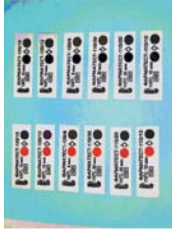
Рис.2. Исходное (1) и конечное (2) состояния индикаторов паровой стерилизации
