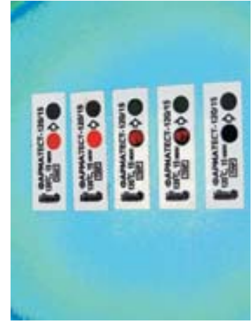
Рис.3. Исходное (1), промежуточное (2, 3, 4) и конечное (5) состояния индикатора Фарматест-Винар-120/15
